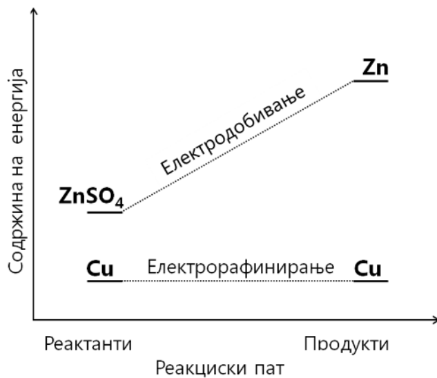
Слика 10-8 Споредба на промената на содржината на енергија при електрорафинација и при електродобивање
