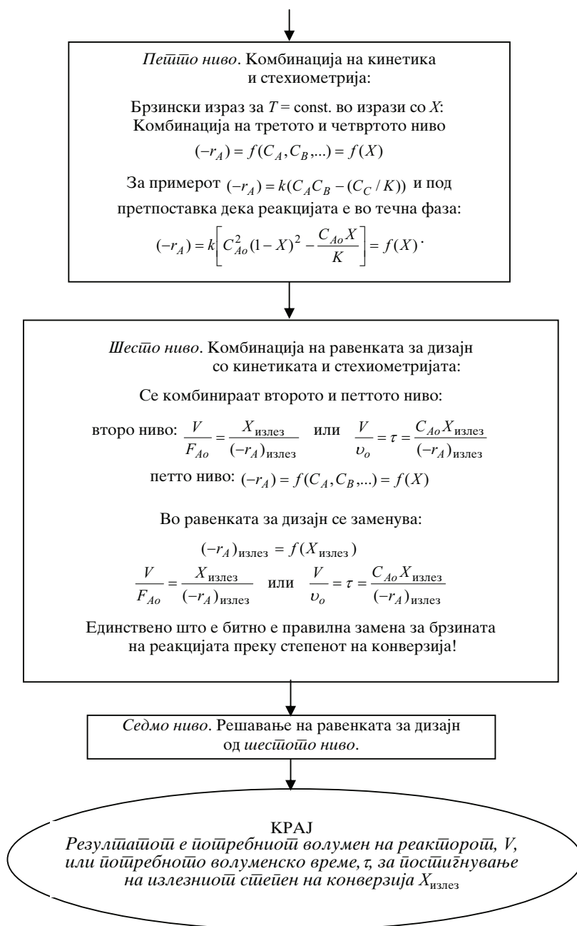
Сл. 20. Логична структура за дизајн на изотермен CSTR
